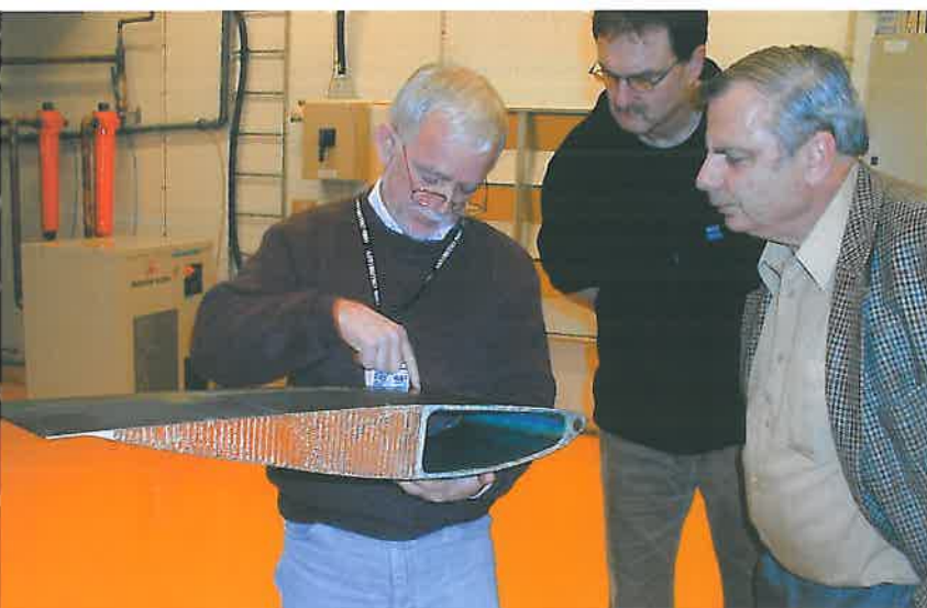
Mr Bruce Thompson Boeing Company, Mats Månsson Flygverkstad Ronneby samt Christer Björkman CSM, studerar resultatet av provblästring. Här ett avkapat rotorblad till en Chinook-helikopter.
