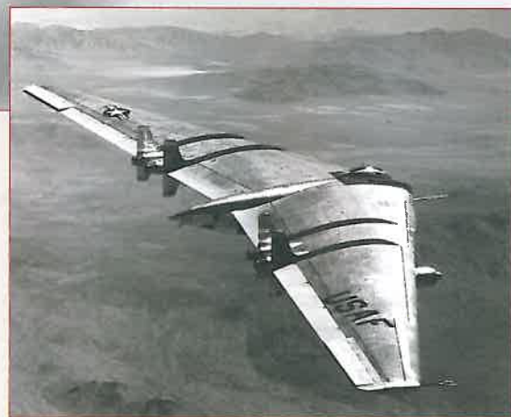
YRB-49A i luften över Mojaveöknen. Lägg märke till fenorna och "stängslena" på vingovansidan.
